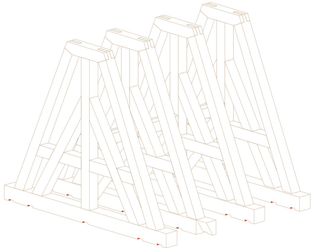
Verkämmung der Glockenturmbalken zu den Deckenbalken teilweise nicht vorhanden siehe auch Pläne des Turmschiffes oder durch Ausbau und Ersatz der Deckenbalken durch höherer Sanierung nicht wirksam
